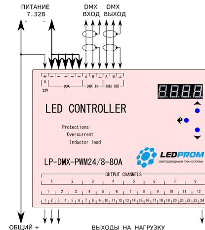
\* Питание нагрузки и контроллера должно осуществляться от одного источника питания. В схеме стоит обратный диод от выбросов индуктивной нагрузки.
